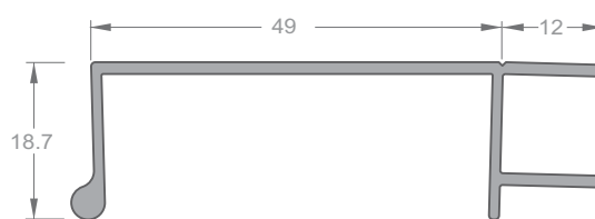
90 deg RETURN JAMB Part No 3837
