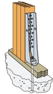
**Vertical HDU8-SDS2.5 installation**
