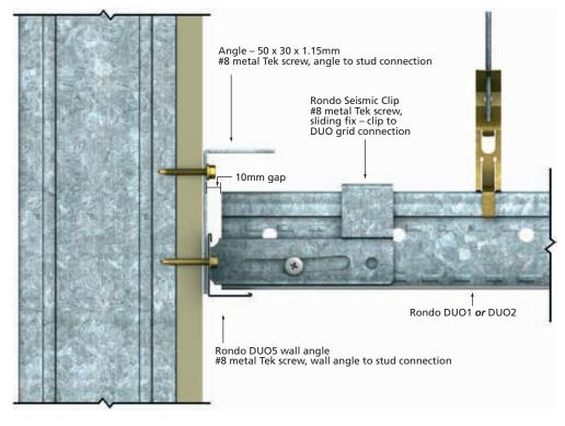
DUO GRID FIXING TO STUDWALL — SLIDING CONNECTION
