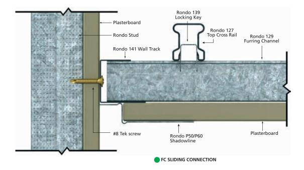
KEY-LOCK<sup>®</sup> SLIDING PERIMETER CONNECTION DETAIL
