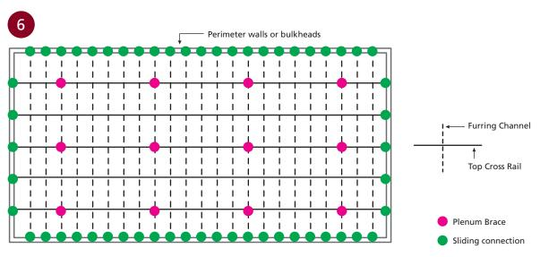
KEY-LOCK® CEILING PLAN – TYPICAL PLENUM BRACING ARRANGEMENT
