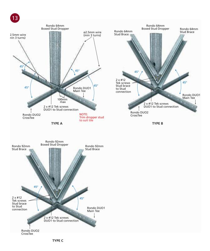
DUO<sup>®</sup> PLENUM BRACING – TYPICAL DETAILS
