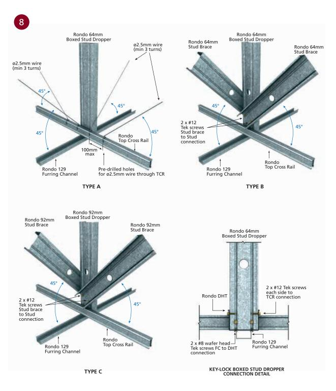
KEY-LOCK<sup>®</sup> PLENUM BRACING – TYPICAL DETAILS
