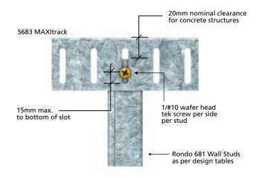
TYPICAL MAXITRACK FIXING DETAIL
