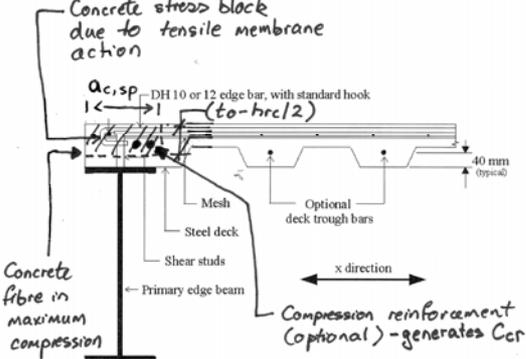
Concrete stress block due to tensile membrane action
