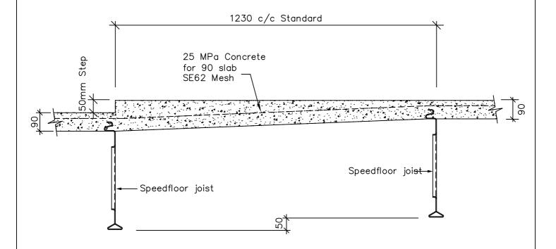
50mm STEP IN SLAB (STEP PARALLEL TO JOISTS)
