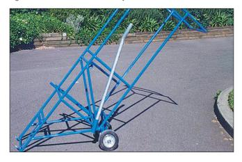
Fig. 4.3 – Hebel hoist
