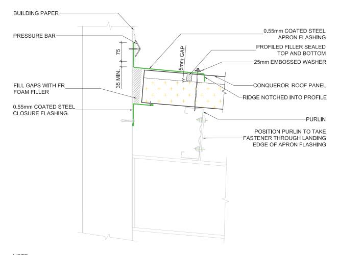
NOTE: POSITION PURLIN TO TAKE LEADING EDGE OF FLASHING
