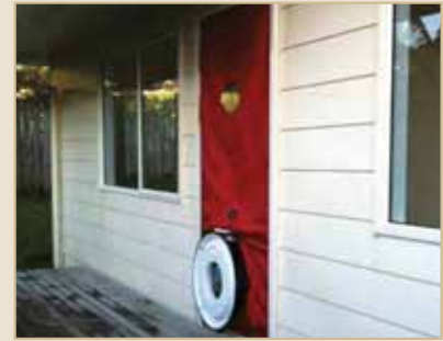
Figs. 61, 62, 63, 64. Blower Door test
