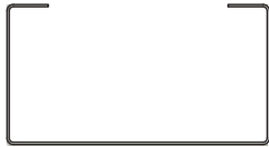
STEEL STUD STUD 63.5/0.55 x 2400mm STUD 63.5/0.55 x 2700mm STUD 63.5/0.55 x 3000mm STUD 63.5/0.55 x 3300mm STUD 63.5/0.75 x 3600mm
