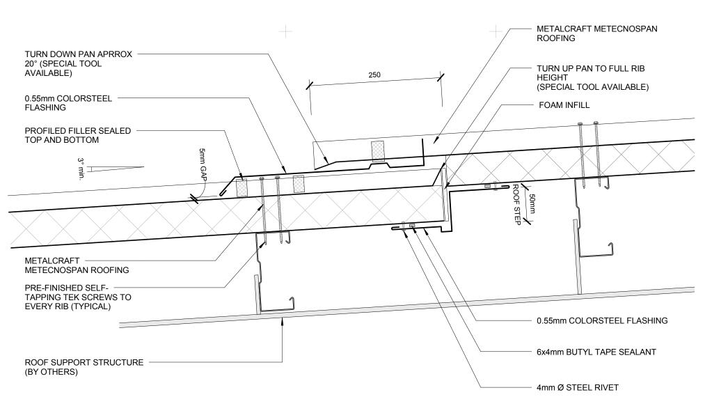
**DETAIL RECOMMENDED** WHERE ROOF RUNS EXCEED 16m
