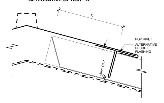
RIDGE FLASHING **COMMERCIAL ROOFING** Espan 340™ / 470™
