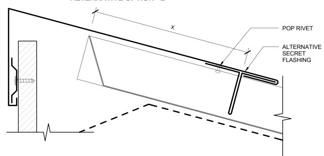
SAWTOOTH EAVE RESIDENTIAL ROOFING Espan 340™ / 470™ Rev: R0 Sheet **03 / 20**
