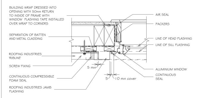
SOAKER FLASHING MAY BE REQUIRED IN WIND ZONE GREATER THAN VERY HIGH. BACK TRAY TO RUN FROM TOP OF HEAD FLASHING TO GROUND OR EXIT POINT.
